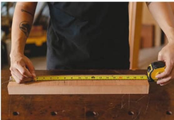
Otro instrumento para hacer mediciones de longitud es la cinta métrica, que es una cinta de plástico o lámina flexible graduada en metros y con subdivisiones de éste; se usa para medir superficies planas y curvas. También se le llama flexómetro porque puede enrollarse y, en algunos casos, retraerse dentro de una pequeña caja.
