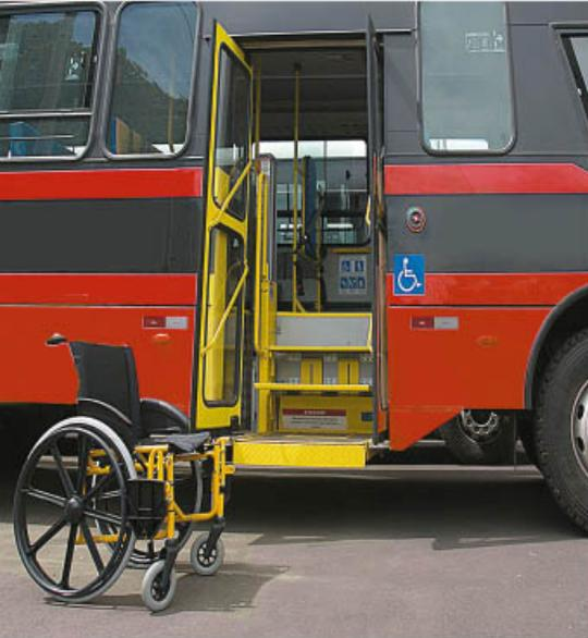
Al accionar un elevador, abrir o cerrar las puertas de los camiones, utilizar un gato hidráulico para levantar un auto o remover piedras con una pala mecánica se aplica el principio de Pascal. Todos estos aparatos cuentan en su interior con una prensa hidráulica, la cual permite aplicar una fuerza en un extremo y que ésta se transmita íntegramente en el interior y en las paredes de los tubos que conducen el fluido, obteniendo al final de la prensa una fuerza que realiza el trabajo.
