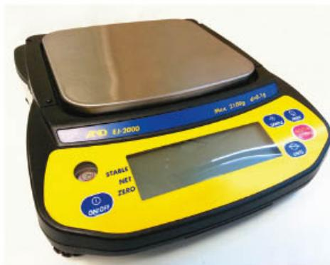
Para medir la masa, actualmente existen básculas digitales graduadas en kilogramos. También se usan las básculas mecánicas, las cuales tienen un brazo y una pequeña pesa que, dependiendo de dónde se coloque, alcanza el equilibrio si la masa del objeto coincide con la marcada en la pesa.
