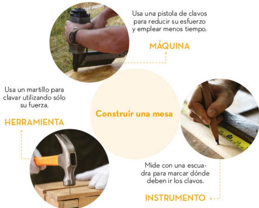
Como se puede observar en el esquema anterior, las herramientas, máquinas e instrumentos tienen funciones específicas, dependiendo de las necesidades productivas de quien o quienes realizan un trabajo. Se puede decir que las máquinas y herramientas amplían las capacidades físicas, mientras que los instrumentos extienden las habilidades perceptivas y cognitivas, como medir, calcular o registrar algo.
