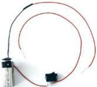
6. Usa la batería, el cable y el interruptor para armar un circuito eléctrico: conecta los extremos de los cables con las patas que quedaron libres en el paso anterior. Observa la imagen de la siguiente página para saber cómo debe quedar la conexión. Verifica que cada led encienda.
