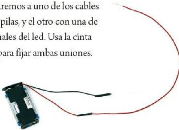
4. Ahora, toma uno de los cables cortos y une uno de los extremos con el otro cable del porta pilas. Usa cinta de aislar.
