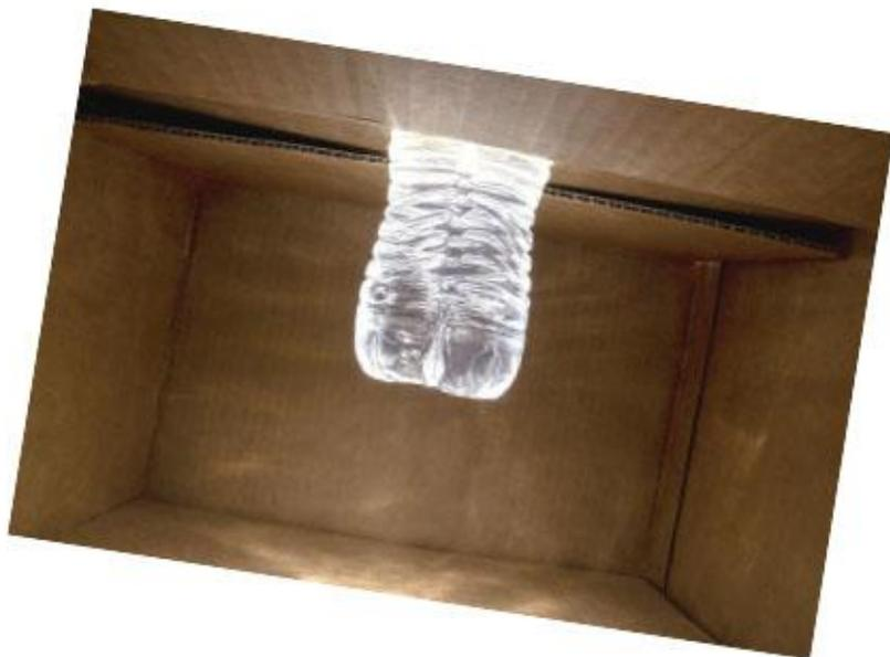
6. Coloquen la botella con agua en el agujero. La parte que contiene el agua debe quedar en el interior de la caja y la otra parte, por fuera de ella. Apliquen el silicón para fijar la botella.
